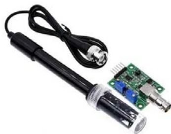
» Figura 7. Equipamento automático para medida de pH.
