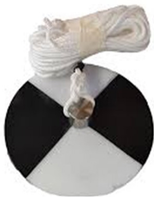
» Figura 10. Disco de Secchi montado com material alternativo.
