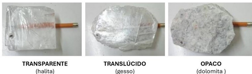
» Figura 4. Teste de diafaneidade de minerais.
