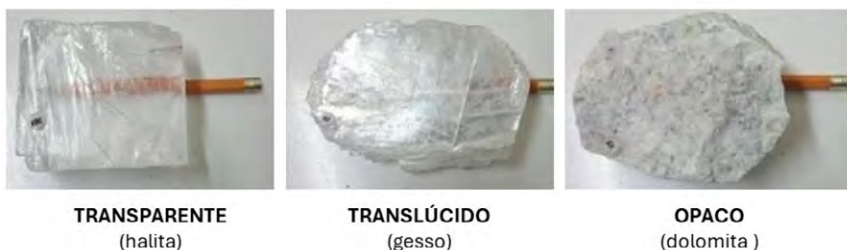
» Figura 4. Teste de diafaneidade de minerais.
